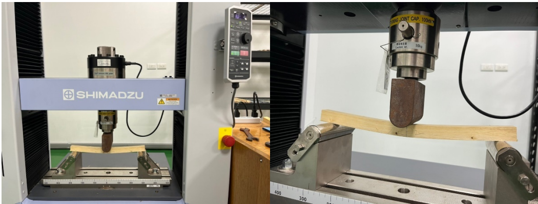
圖 1 不同年份銀合歡及市售木材之抗彎強度測試。
