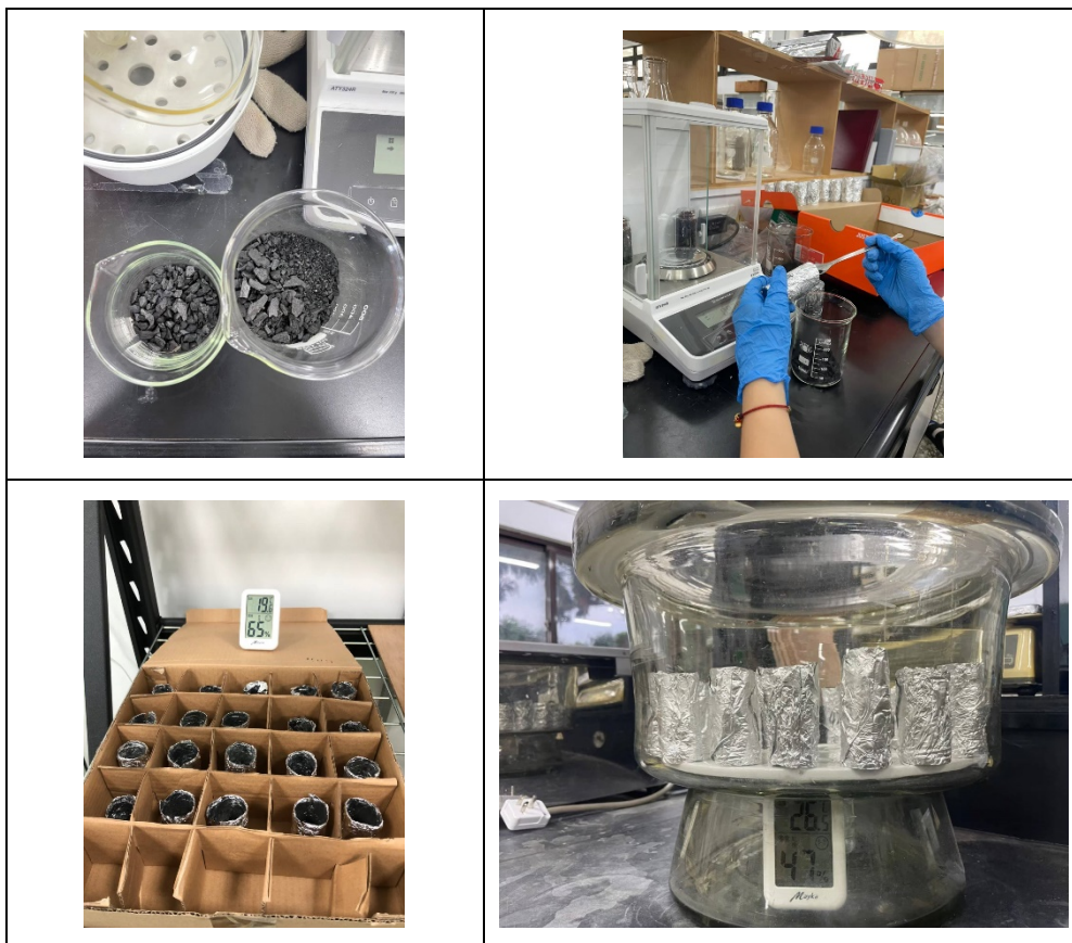
圖 11 銀合歡炭材及市售炭材之吸濕試驗
